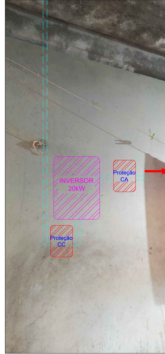
Local para instalação do inversor
